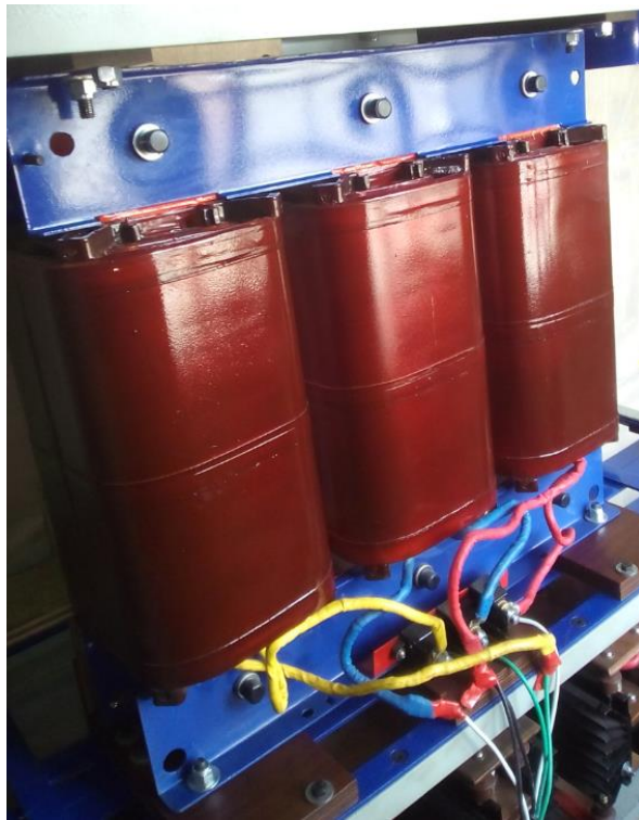
Figura 2. Transformador reductor de tensión. En primario 208 V, secundario 20 V. El autor.
