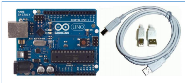
Figura 8. Tarjeta controladora Arduino
