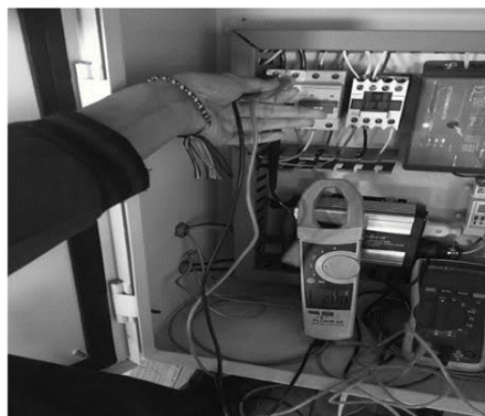
Figura 7: Ejemplo de lectura de voltaje
