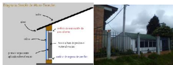
Figura 3. a) Principio de funcionamiento de un muro Trombe. b) Foto de la escuela donde se instaló el muro Trombe.
