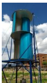
Figura 4. Turbina eólica tipo Savonius de doble cuerpo construida para un sistema de iluminación solar eólico en la Universidad Distrital FJC.
