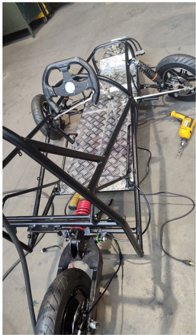
Ilustración 60 Etapas de fabricación – Chasis - suspensión - dirección
