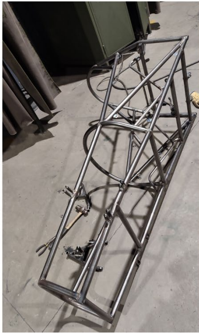
Ilustración 60 Etapas de fabricación – Chasis - suspensión - dirección
