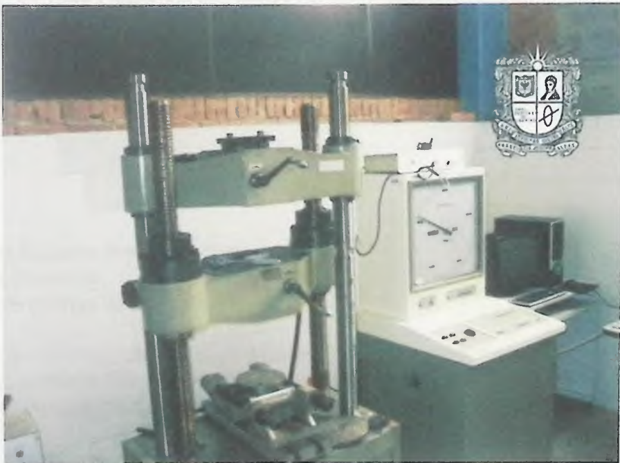
Figura 7. Máquina de ensayos de accionamiento hidráulico.
