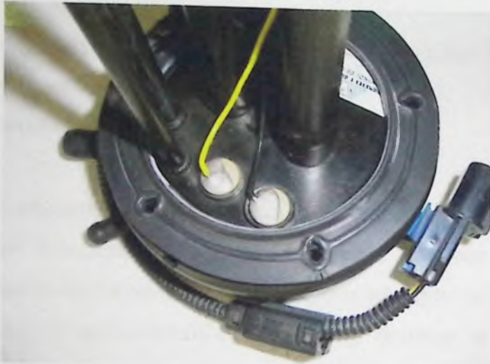
FIGURA N° 6 NOMBRE: MUESTRA (ENVIADA POR EL CLIENTE) DESCRIPCIÓN: vista inferior para observar el empaque y la conexión de cables de masa y señal.
